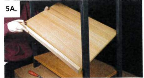
Werden Bodenträger eingesetzt, kann der Fachboden nun von oben in die eingesteckten Bodenträger gedrückt werden
