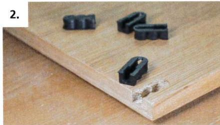
Verbinder auf dem Bearbeitungszentrum fräsen oder bohren
