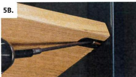
Bei Anwendungen mit Schrauben wird der Fachboden ebenfalls aufgelegt. Zusätzlich werden die vormontierten Schrauben festgezogen
